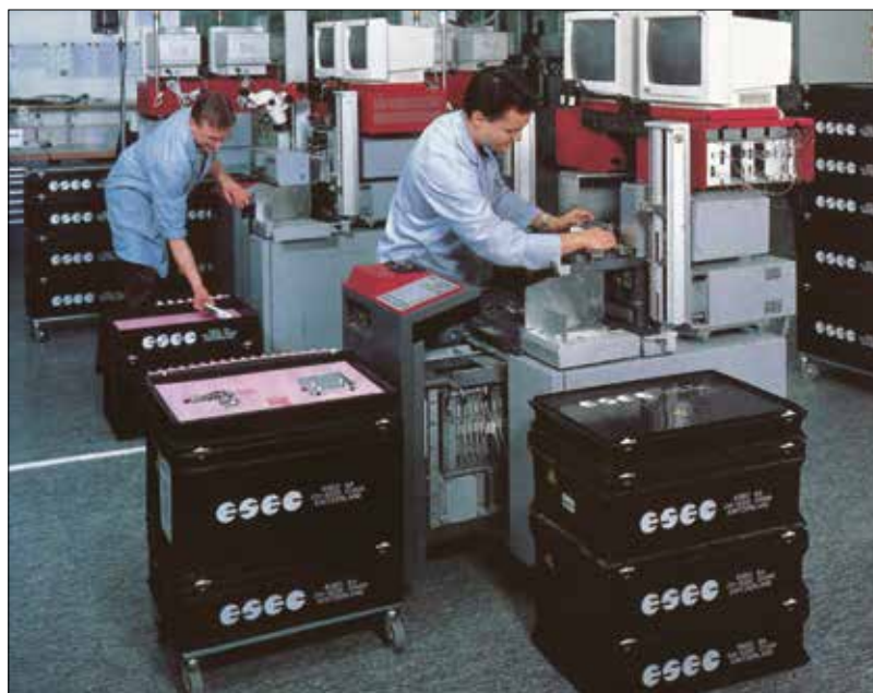
In einer ESD-sicheren Arbeitsumgebung sind nicht nur die Behälter, sondern auch der Boden, die Schuhe, die Arbeitsplätze und Wagen leitfähig!
